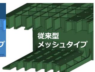
フォーク爪挿入時に破損しにくい！
