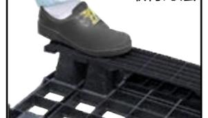
パレットを裏返して、平らな場所に置きます。ベースボードの突起をパレット脚部の穴位置に合わせ、足で踏んでパチッと音がするまで押し付けます。
