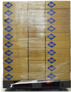
荷崩れ防止措置有り
