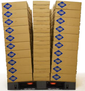
荷崩れ防止措置無し
