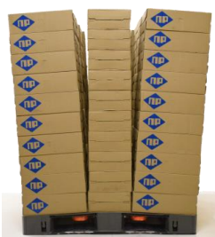
▲EXA1111 カートン棒積み 荷崩れ防止措置なし
