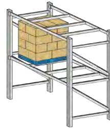
カートの固定ラック保管
