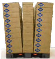
▲EXA1111 カートン棒積み 荷崩れ防止措置なし
